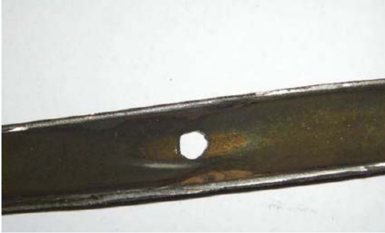
Figure 1 : Vue macro, percement tube en interne
